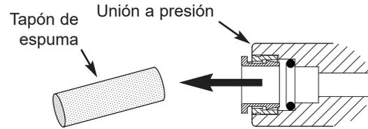
Retire y elimine los tapones de espuma FIG. 16
