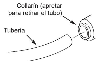
**Desconecte la tubería FIG. 29**
