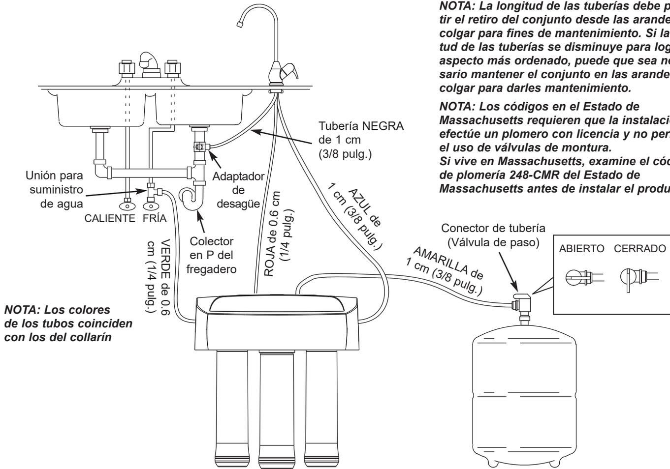
**NOTA:** La longitud de las tuberías debe permitir el retiro del conjunto desde las arandelas de colgar para fines de mantenimiento. Si la longitud de las tuberías se disminuye para lograr un aspecto más ordenado, puede que sea necesario mantener el conjunto en las arandelas de colgar para darles mantenimiento.
