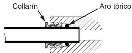
Tubo totalmente acoplado a la unión FIG. 19
