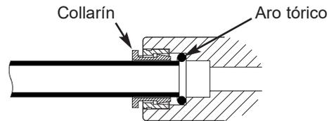
Tubo parcialmente acoplado a la unión FIG. 18
