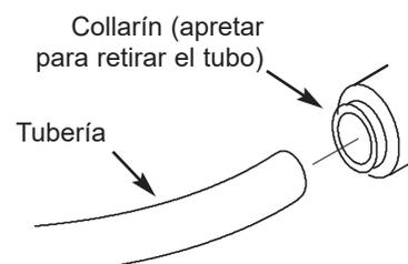
**Desconecte la tubería FIG. 29**
