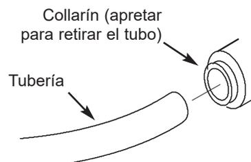
Desconecte la tubería FIG. 31
