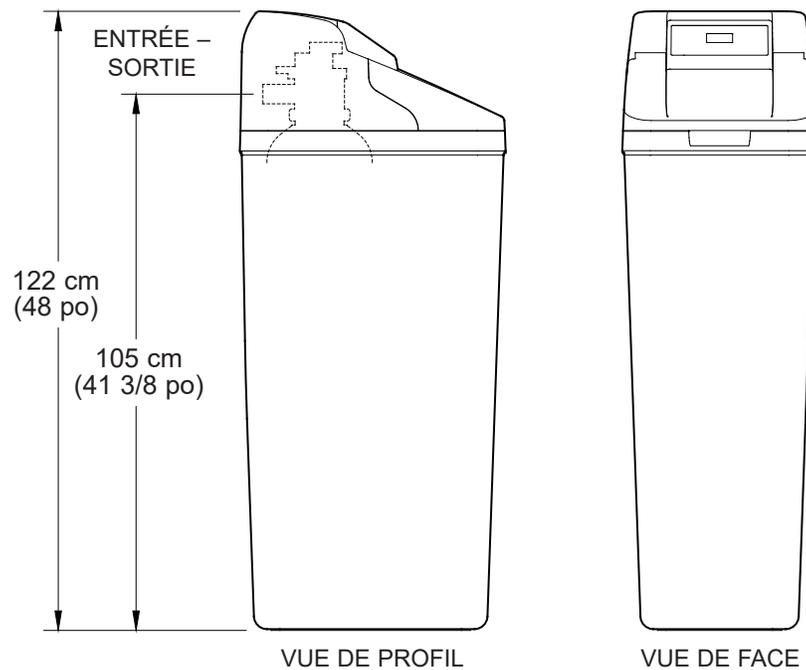
**REMARQUE :** En raison de variations dans la production et l'assemblage, la hauteur de la vanne d'adoucisseur d'eau peut varier jusqu'à 1/2 po, et peut ne pas correspondre aux systèmes précédemment installés. Cela n'affectera pas les performances du système.
